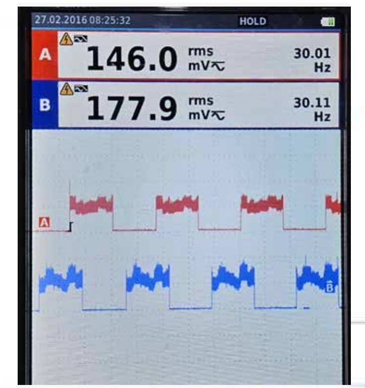
Señales de encoder TTL
